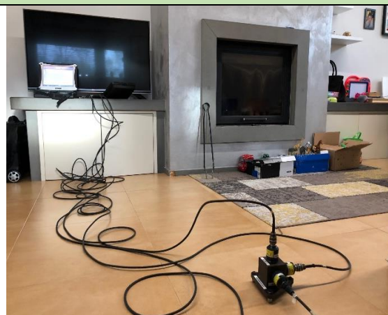
Posizionamento accelerometri monoassiali, piano primo
