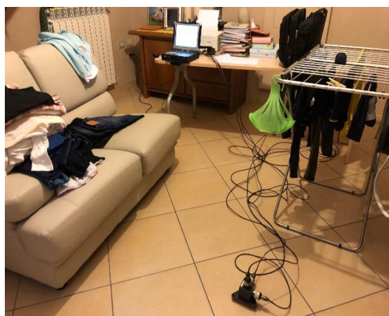
Posizionamento accelerometri monoassiali, piano terra
